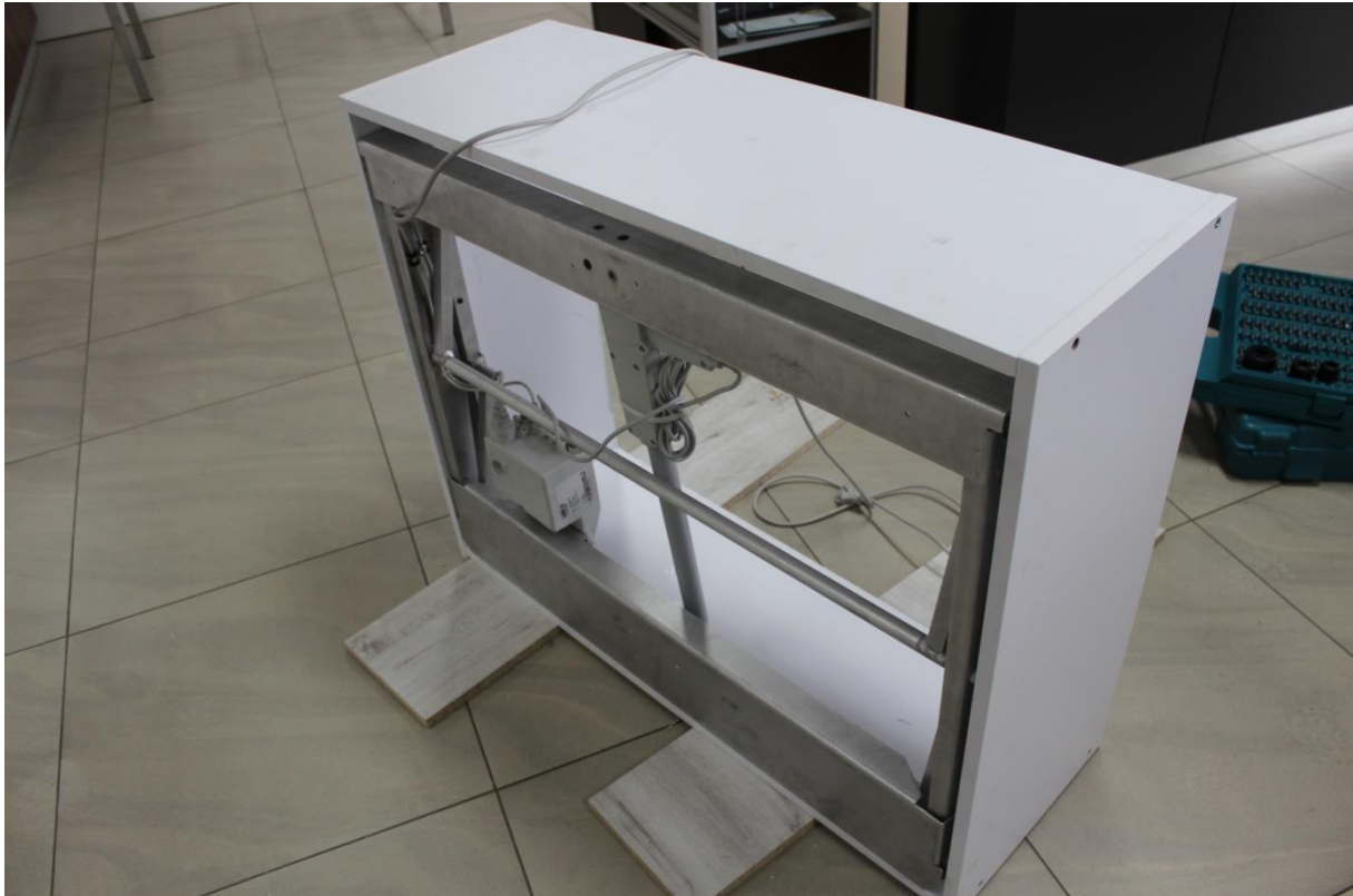
zdj 5. Zabudowa stelaża podnoszenia/opuszczania w korpusie szafki meblarskiej.
