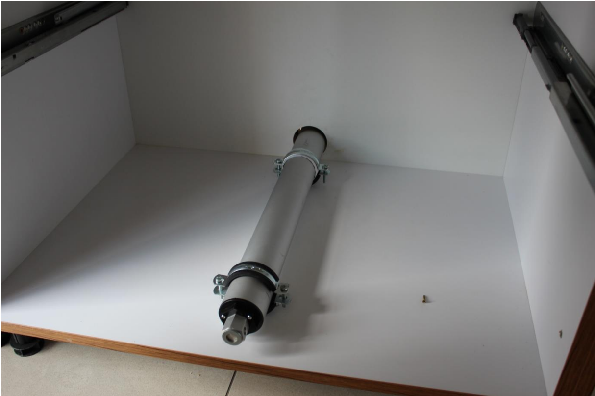
zdj 3. Zamontowany siłownik, wraz z widocznymi prowadnicami szuflady
