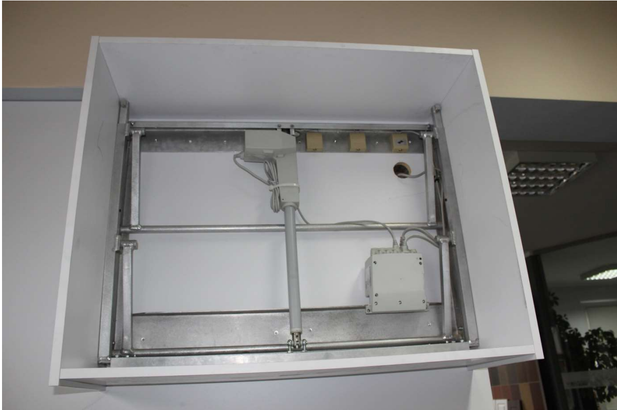
zdj 16. Zespół opuszczania i podnoszenia szafki zamontowany na ścianie.
