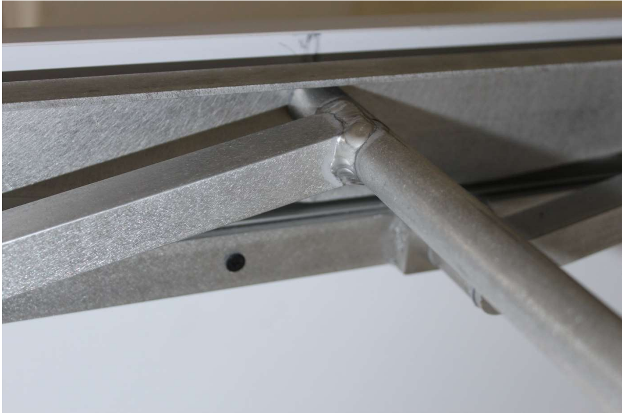
zdj 12. Stelaż mechanizmu szafki opuszczanej z usuniętą poprzeczką regulacyjną.
