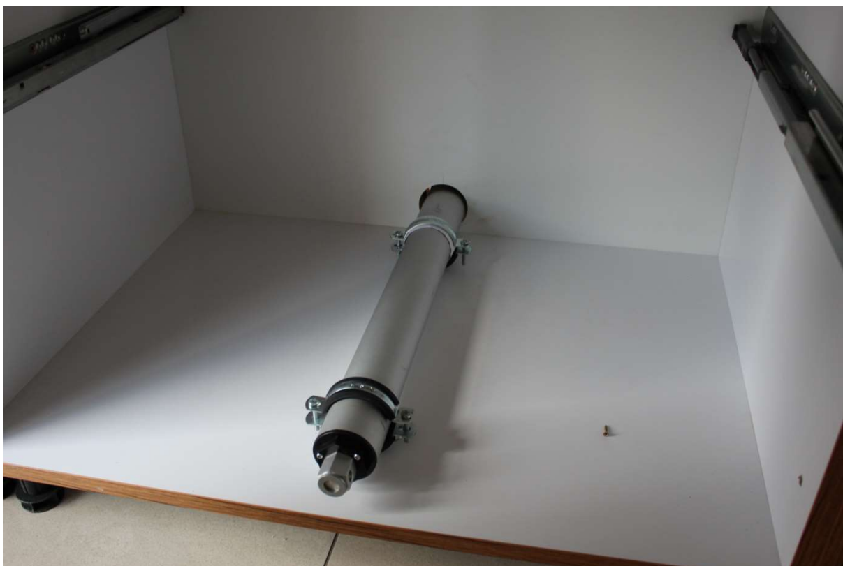
zdj 8. Zamontowany siłownik, wraz z widocznymi prowadnicami szuflady
