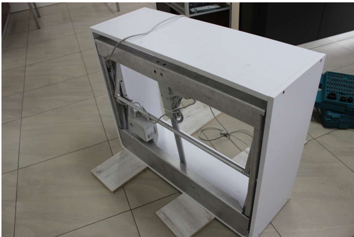
zdj 11. Zabudowa stelaża podnoszenia/opuszczania w korpusie szafki meblarskiej.
