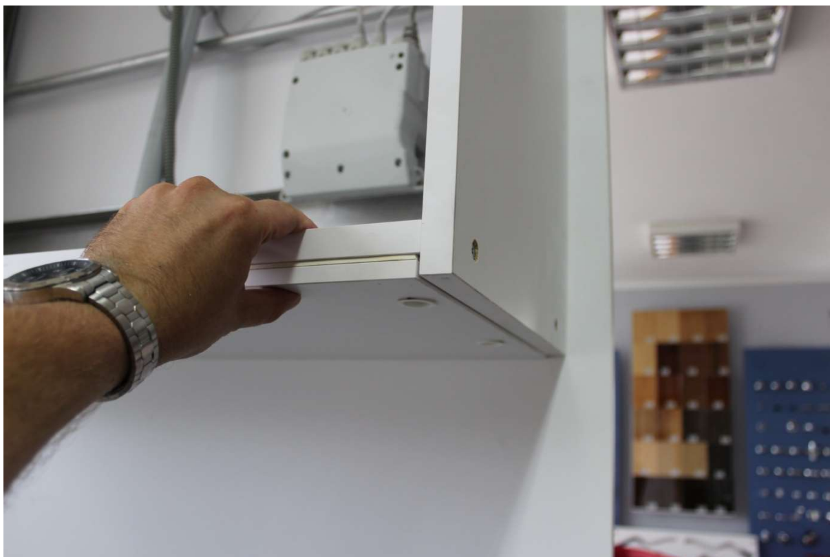
zdj 15. Działanie systemu - wciśnięcie płyty bezpieczeństwa.
