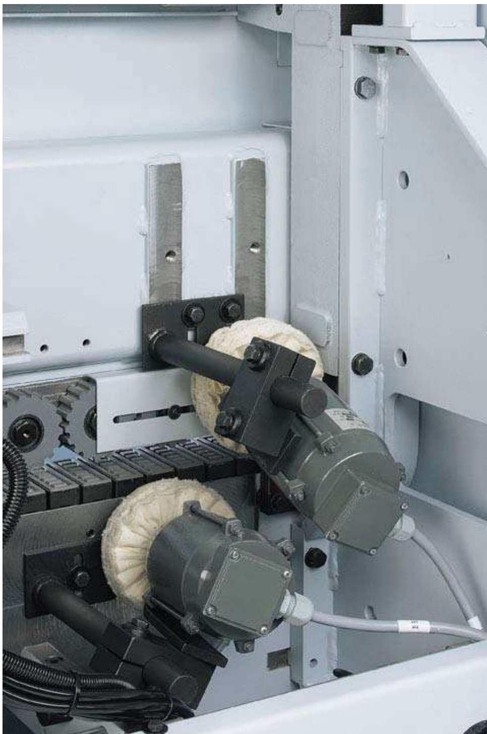
jednostka do polerowania (wykańczająca) - źródło, mat. producenta.
