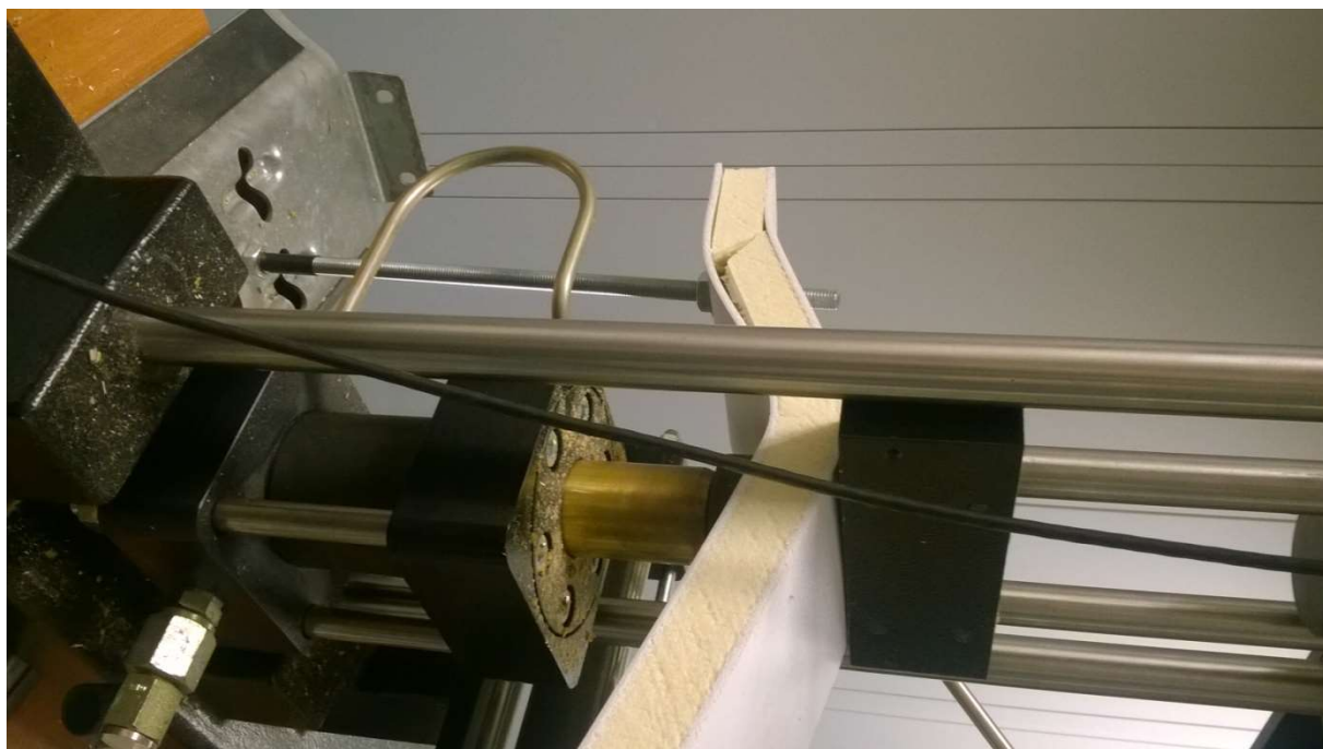
Próbka nr 12. Klej trzyma, HDF wchłonał, klej wyschnięty. Próbka podczas badań.
